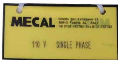
Placa tensión de alimentación
