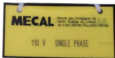
Placa tensión de alimentación
