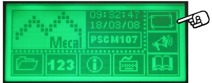
All'interno del menu di selezione del ciclo di lavoro viene visualizzato, nell'icona più centrale, il tipo funzionamento attualmente impostato.
