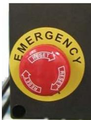
Se si verificasse la necessità di arrestare la macchina in qualsiasi momento del ciclo, premere il pulsante di emergenza. Il pulsante d'emergenza toglie corrente all'attrezzatura e scarica l'impianto pneumatico.
