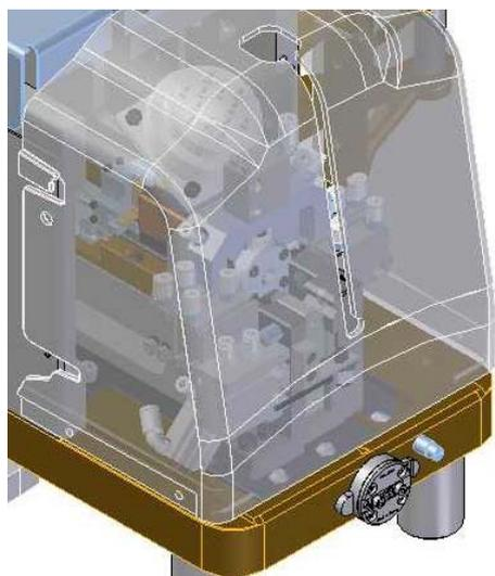
Il carter ha una feritoia particolare che permette, a fine ciclo, l'estrazione del cavo senza compromettere il risolto della calza.
