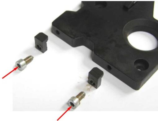
Rimuovere le n°2 viti che tengono i dentini di bloccaggio fissati sulla basetta.
