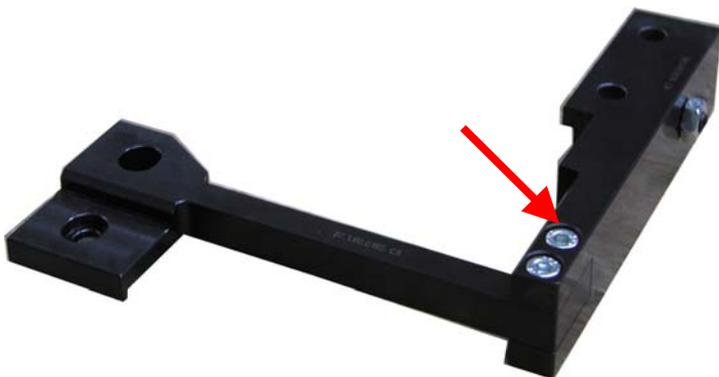
Fissare il dentino fisso e la relativa staffa di supporto in dotazione nel kit con le n°2 viti M5x18 comprese nell'attrezzatura.
