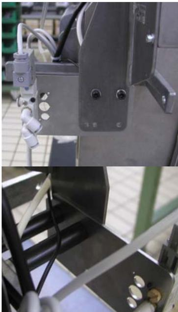
Rimuovere temporaneamente le viti che tengono la cella di carico fissata sul lato della pressa. Dopo aver posizionato la piastra di supporto dell'elettrovalvola del BCC tra i distanziali (già presenti se la pressa fosse equipaggiata con cella TT1000) e la cella di carico, serrare le viti.
