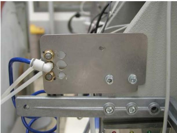
Montare sul lato della pressa la piastra di supporto dell'elettrovalvola del BCC con le relative viti M6x12.
