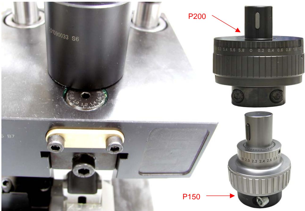
Quando lo stampo è di tipo "X" (vedere paragrafo 1 Pag4 Avvertenze importanti) la regolazione dell'altezza di aggraffatura avviene mediante la ghiera in continuo montata a bordo della pressa. La pressa P200 monta di serie la ghiera 951270110 con un campo di lavoro di 5,8 mm e una risoluzione di 0,1mm ogni scatto mentre la pressa P150 monta di serie la ghiera 951270150 con un campo di lavoro di 3,6mm e una risoluzione di 0,1mm.
